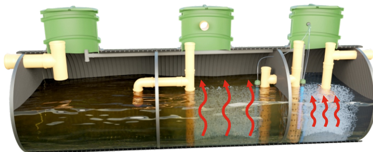
А) - підготовка очисної споруди до прийому перших стічних вод протягом доби, шляхом попередньої оксигенації - активація біокамери.
