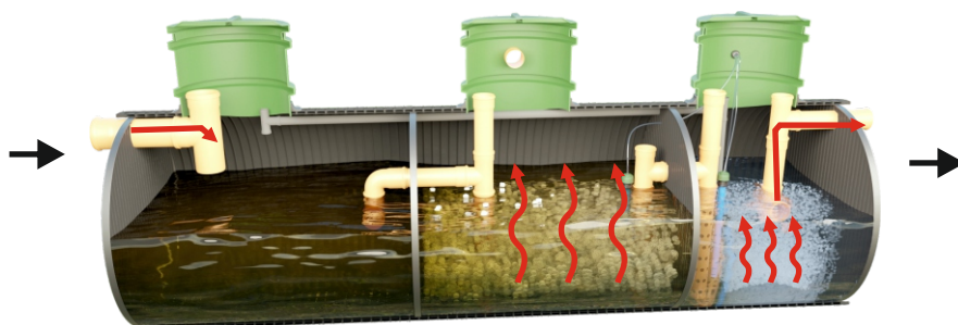
С) - подальше надходження стічних вод з продовженням оксигенації
