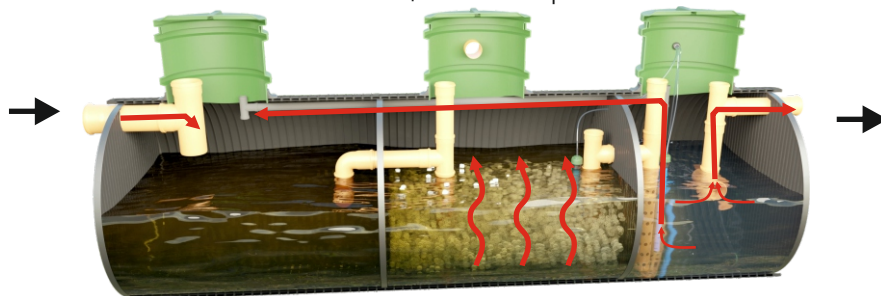
В) - періодична рециркуляція осаду з перервами оксигенації
