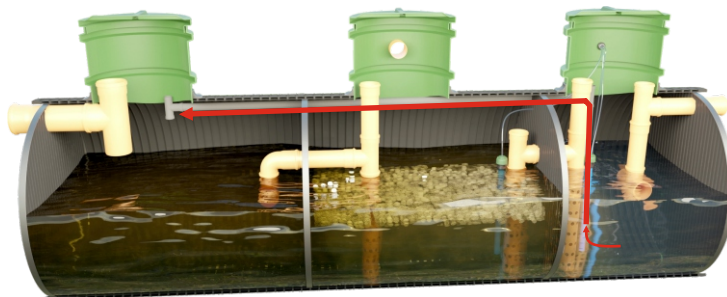
С) - подальше надходження стічних вод з продовженням оксигенації
